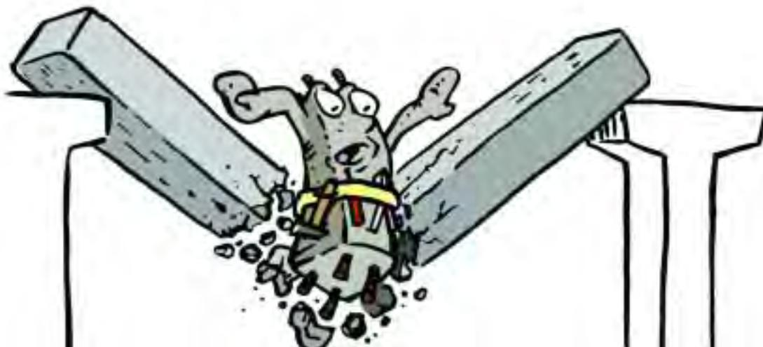
L'INSERIMENTO DI BARRE D'ACCIAIO NEL CALCESTRUZZO SERVE PER AUMENTARE LE CARATTERISTICHE DI RESISTENZA A TRAZIONE DELL'INSIEME.
